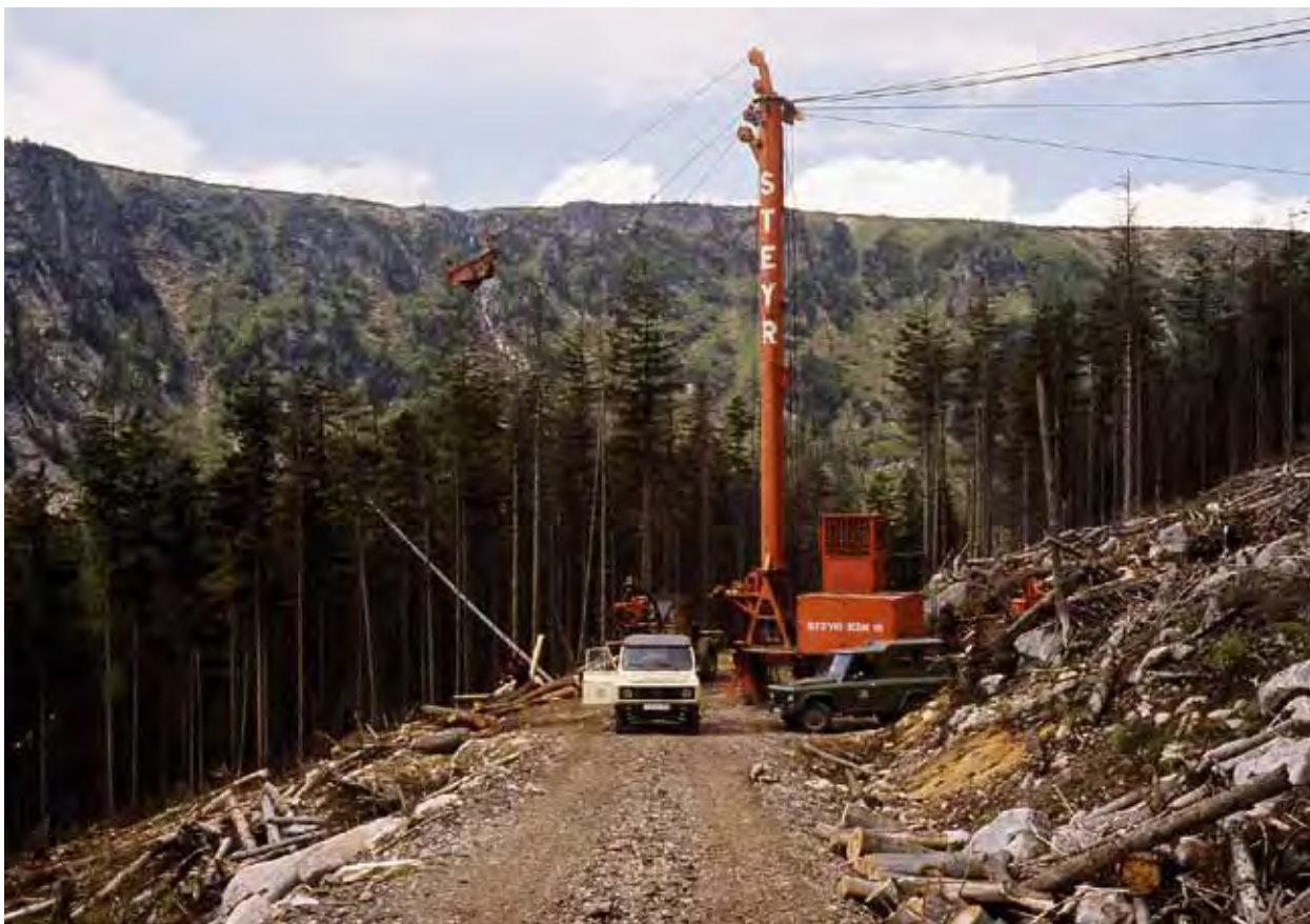
Kolejka linowa Steyr na szlaku zrywkowym Lavina w dolinie Labský důl (za krążkiem widać wodospad Pančavský vodopád ). To austriackie urządzenie o dużej mocy każdego dnia przetransportowało ogromną ilość materiału. W ten sposób dzień po dniu szybko zmieniał się wygląd objętego ścisłą ochroną karkonoskiego krajobrazu. (fot. Jan Štursa)
