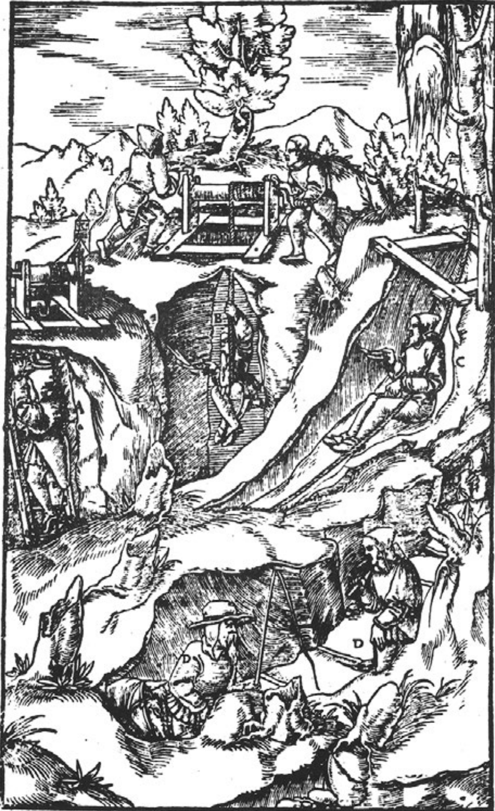
Drabinki, pionowe i ukośne wciągarki, wyciosane schody, ludzka i zwierzęca siła – w ten sposób ludzie ułatwiali sobie poruszanie się w trudnym środowisku szybów i odkrywek. Ilustracja z dzieła Jiřího Agricoly.
